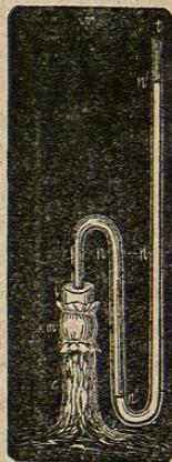
FIG. 193.—Aparato para demostrar y medir la fuerza ascendente de la savia.
