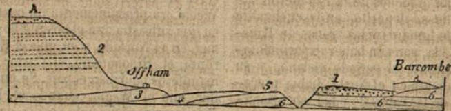
A. Corte del escarpado Norte de los Downs del Sur en Barcombe. 1. Lecho de pedernales de la creta no redondeados.—2. Guijo compuesto de pedernales de la creta en parte redondeados.—3. Creta con y sin pedernal.—4. Gault.—5. Gres Verde Inferior.—6. Arcilla del Weald.
