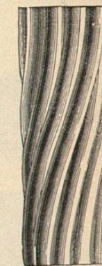
Fig. 359.—Cable submarino de varios hilos.
