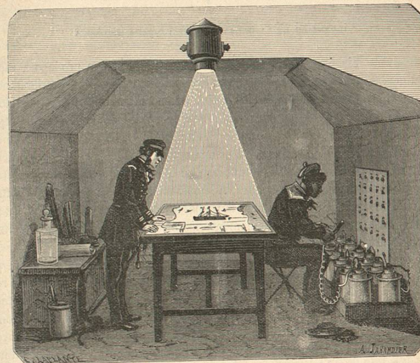
Fig. 482. — Explosión de torpedos por medio de la electricidad: sistema de defensa de los puertos y costas, del general Chazal
