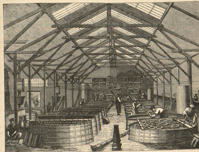
Fig. 491.—Taller de cobreado galvanoplástico del taller Oudry
