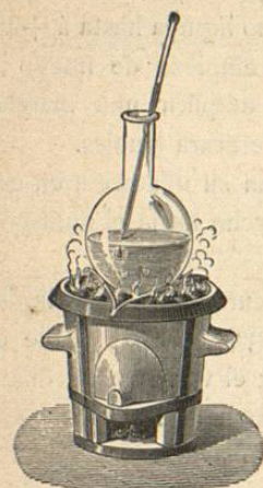
Fig. 561. — Fusión del azufre
