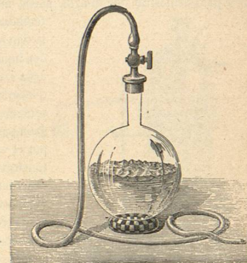
Fig. 583.—Ebullición del agua en el vacío
