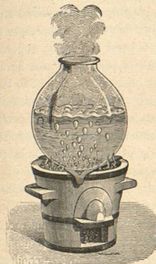
Fig. 582.—Fase de la ebullición completa: las burbujas revientan en la superficie
