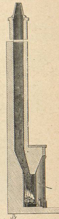
Fig. 679. — Tiro en una chimenea común
