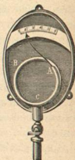
Fig. 744.—Manómetro metálico de cuadrante
