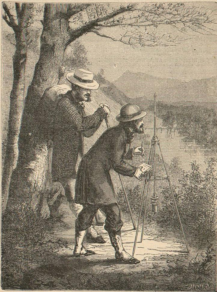
Fig. 34.—Observaciones barométricas en las montañas. Medición de alturas
