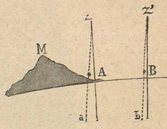
Fig. 111.—Atracción de una montaña: desviación de la plomada en dos puntos situados al Norte ó al Sur
