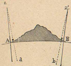
Fig. 110.—Desviación de la plomada por la atracción de una montaña
