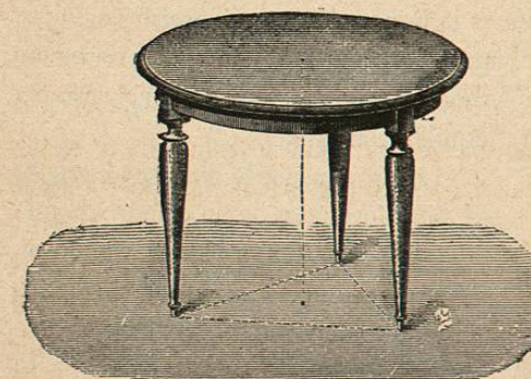
Fig. 151.—Equilibrio de un cuerpo que descansa por tres puntos sobre un plano
