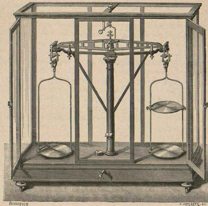
Fig. 163.—Balanza de precisión modelo Hempel
