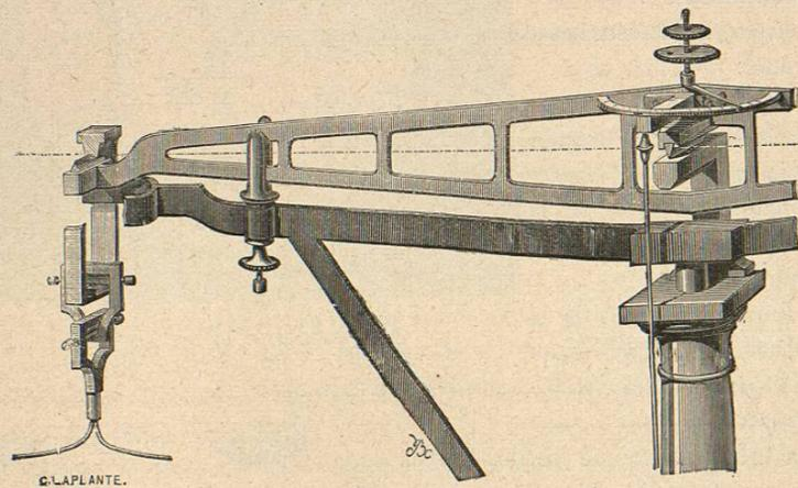
Fig. 162.—Balanza de precisión
