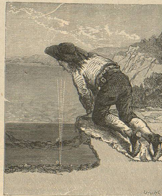
Fig. 471.—Elevación aparente del fondo de un río ó de una vasija. Explicación
