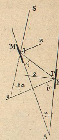
Fig. 617.—Principio teórico del sextante
