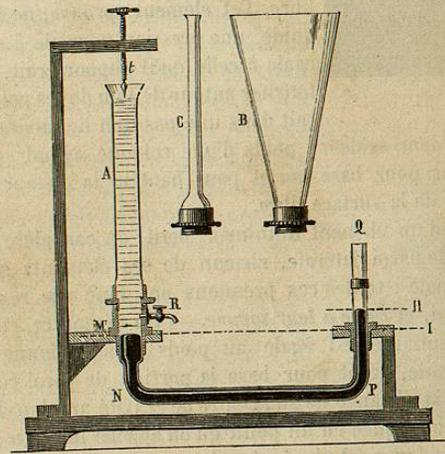
Fig. 54. — Appareil de Haldat.
