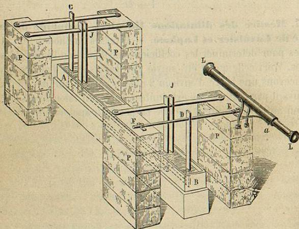
Fig. 197. — Dilatation linéaire des corps solides; appareil de Lavoisier et Laplace.
