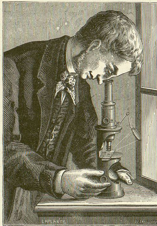
Fig. 245.—Modo de observar con el microscopio compuesto
