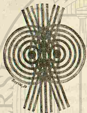
Fig. 135.—Experimento de difraccion. Franjas oscuras y franjas brillantes producidas por un sistema de dos pequeñas aberturas circulares.
