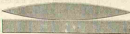
Fig. 140.—Lámina tenue comprimida entre dos cristales uno plano y otro convexo. Experimento de los anillos coloreados de Newton.
