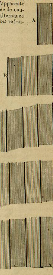
FIG. 23. — Figure théorique, montrant de quelle manière se produisent les couches, par intercalation de matière hydratée, au sein d'une couche dense et déshydratation ultérieure de cette matière.
