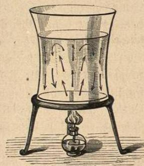
FIG. 52. — Courants dans l'eau chauffée.
