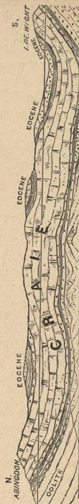
FIG. 67. — Section d'Abingdon à l'île de Wight. (L'échelle verticale est exagérée, relativement à l'échelle horizontale, dans le rapport de 20 à 1.)
