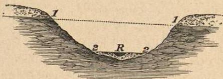
Fig. 85. — Coupe d'une rivière montrant l'ordre des dépôts de graviers.
