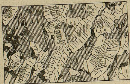
Fig. 23. — Texture granitique (du granite égyptien). — Les surfaces couvertes de hachures fines représentent le quartz; le mica est figuré en noir; le reste correspond au feldspath.
