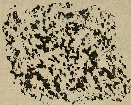
Fig. 27. — Disposition du quartz (partes noires), dans la masse du granite commun.
