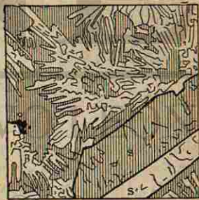
Fig. 31. — Microlithes de feldspath entourant de plus gros cristaux dans un trachyte (grossissement : 80 diam.).
