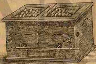
Fig. 16<sup>a</sup>.—Máquina empolladora. Los huevos se calientan artificialmente por medio de un horno.
