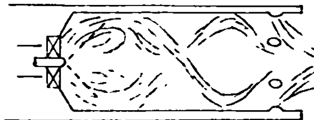
Figura 5-3 Región de estabilidad para la flama creada por las venas de deflectoras.
