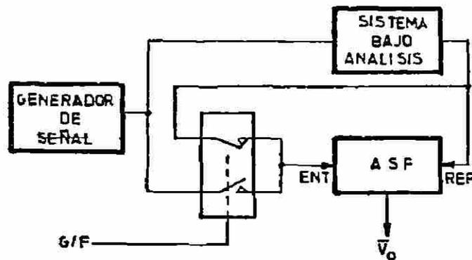
Fig.11 Conmutación para medir ganancia o fase.
