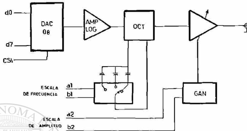
Fig.17.-Diagrama a bloques del generador de la señal de prueba.
