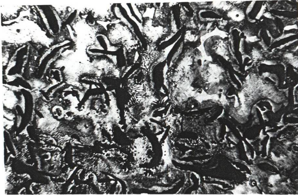
FOTO.5.- MICROESTRUCTURA DE MOLDE INGLES. 100X.
