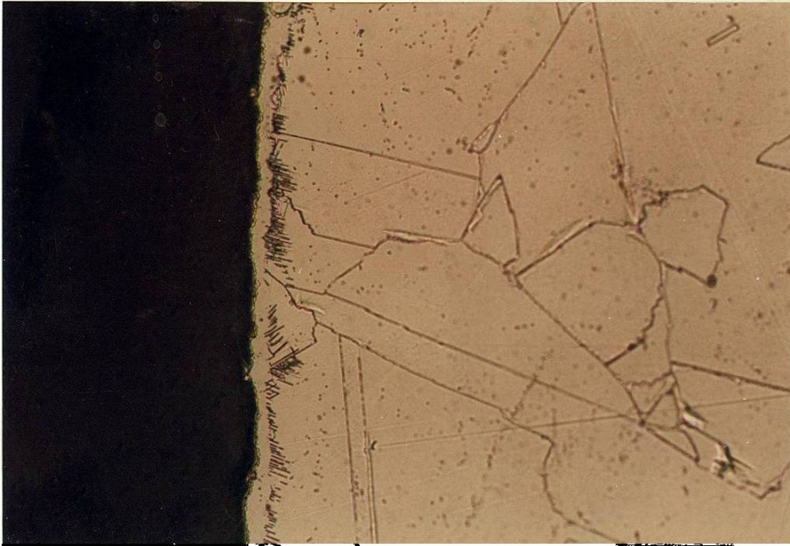
Figura 27. Carburización interna en aceros AISI 304 ( 400 X ). Atacada electrolítica.
