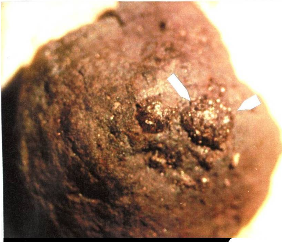
Fig. 5 4.2 Fotografía en estereoscopio donde se muestra la fayalita.
