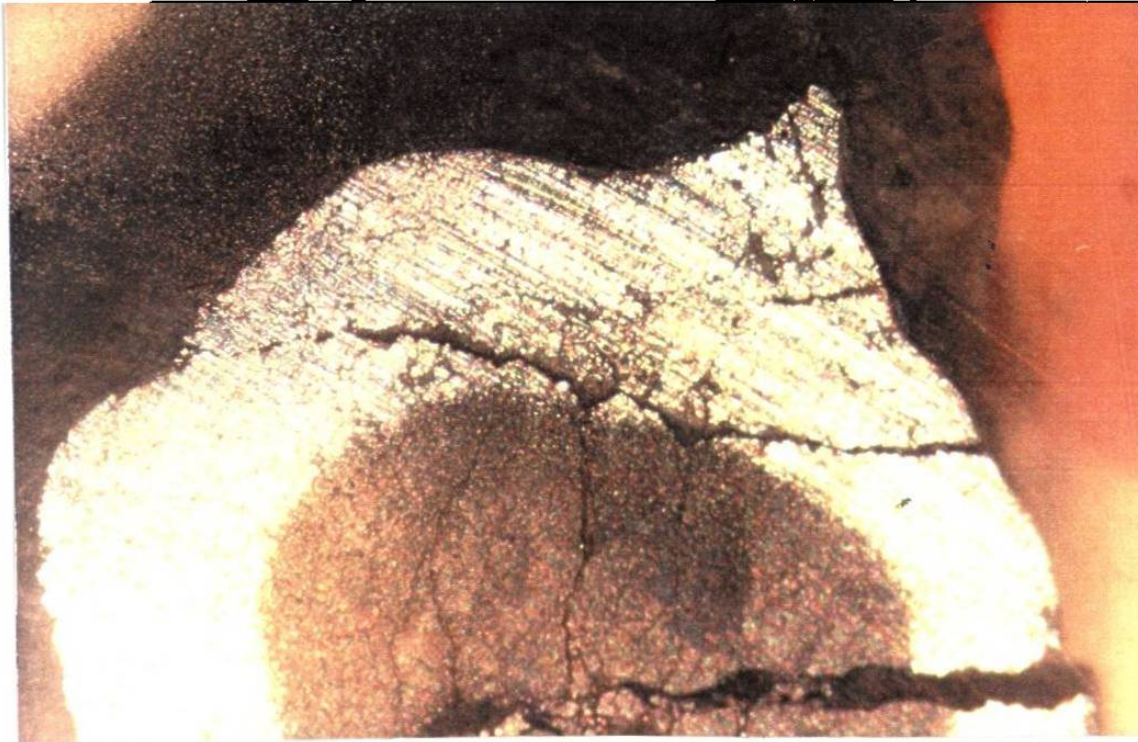
fig. 5.2.2 Fotografía donde se muestra la reducción topoquímica en un pelet de mineral de hierro a una temperatura de 950^{\circ}\text{C} en 55\%\text{H}_2 21\%\text{CO} 14\%\text{CO}_2 y 10\%\text{N}_2 , donde la fase amarilla es hierro metálico y la fase gris es wustita.
