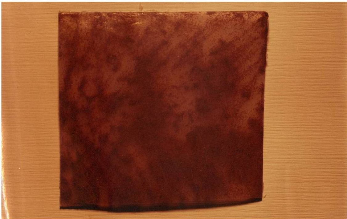
Figura 4.4. Placa del material compuesto elaborada a través de un mezclado en seco (4% en vol. Cu).
