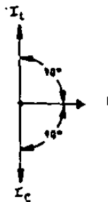
Fig. 6.11 VECTORES DE UN CIRCUITO RESONANTE PARALELO
