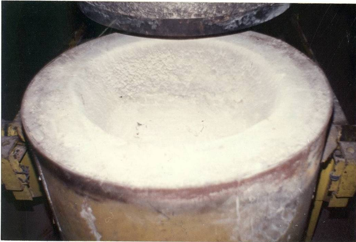
Fig. 3.5.1 Coraza revestida de concreto refractario.
