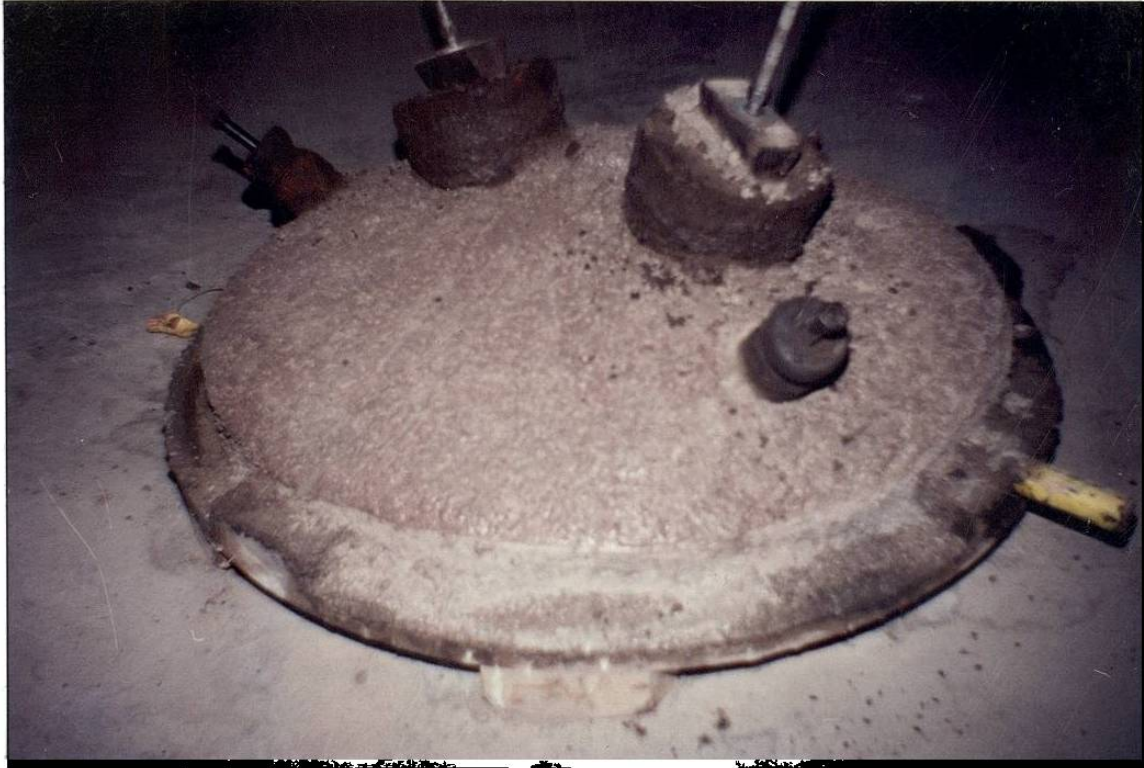
Fig. 3.5.2 Tapa del horno recubierta de concreto refractario de magnesita cromita.
