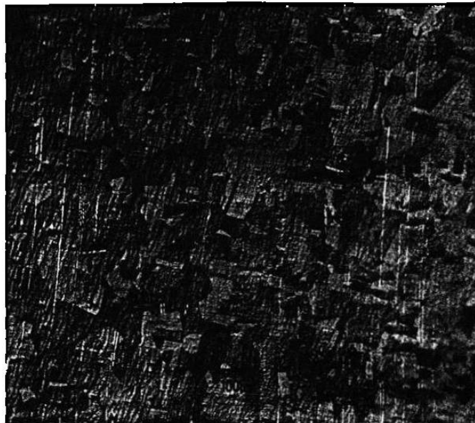
Figura 10. Acero AISI 316L, ácido pícrico, 100X.
