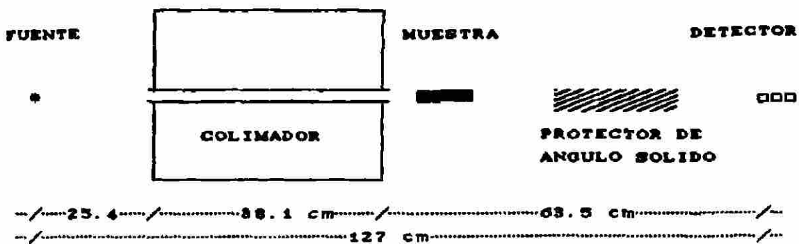
Figura 6.- El colimador y el protector de ángulo sólido tal como se arreglaron en este experimento.
