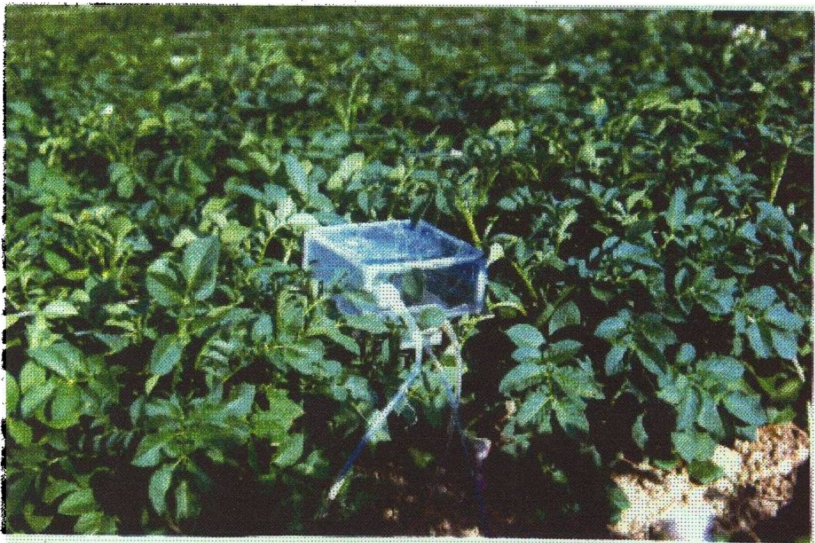
Cámara de Medición de la Asimilación de CO 2
