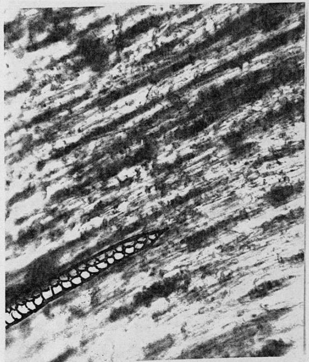
9c. Radios heterogéneos biseriados. (40 X)
