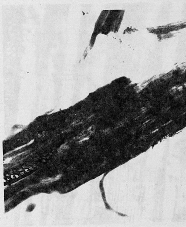
6c. Radios homogéneos biseriados. (40 X)
