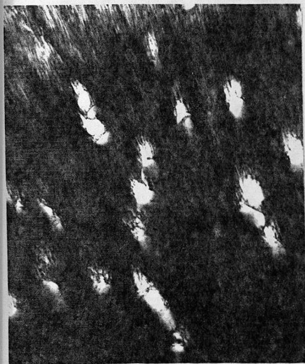
6b. Poros en pares y en línea, parénquima paratraqueal confluente. (40 X)
