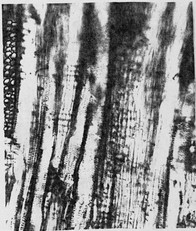
7c. Radios heterogéneos biseriados. (40 X)
