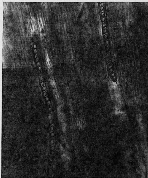
10c. Radios homogéneos uniseriado. (40 x)
