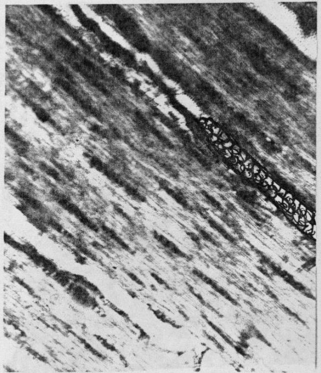
2c. Radios homogéneos biseriados. (40 X)
