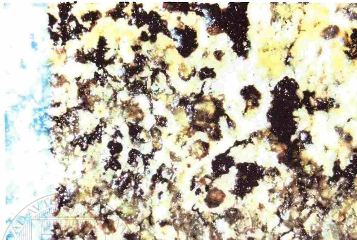
Fotografía 46 Ladrillo tratado con polvo de cal
