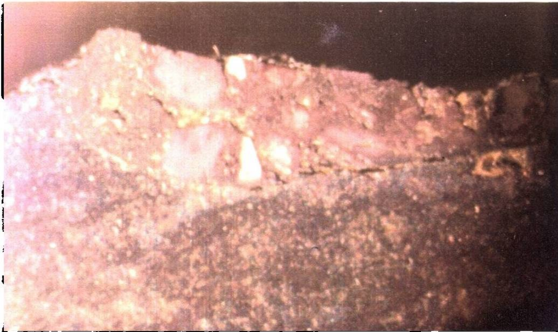
Fotografía 7 Corte transversal de capa con refractario (6x)
