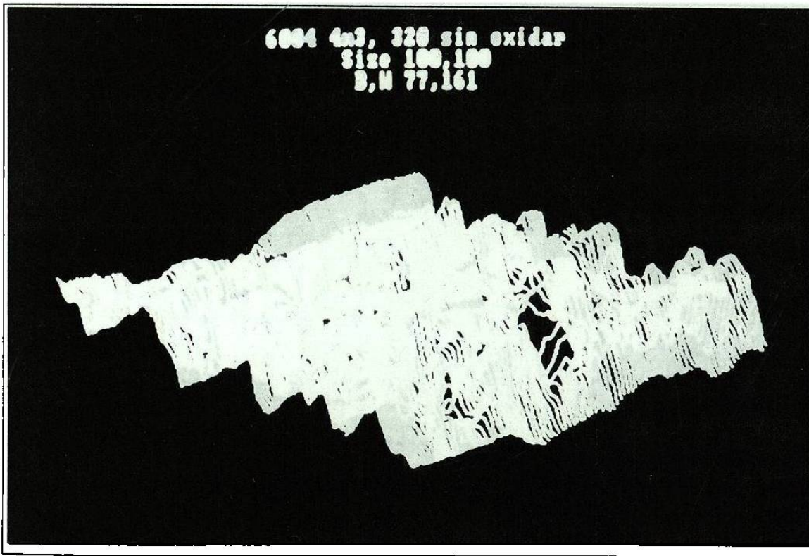
Fig. 11.- Imágen pseudo-tridimensional acero 316L, sin oxidar, pulido lija 320 SiC.
