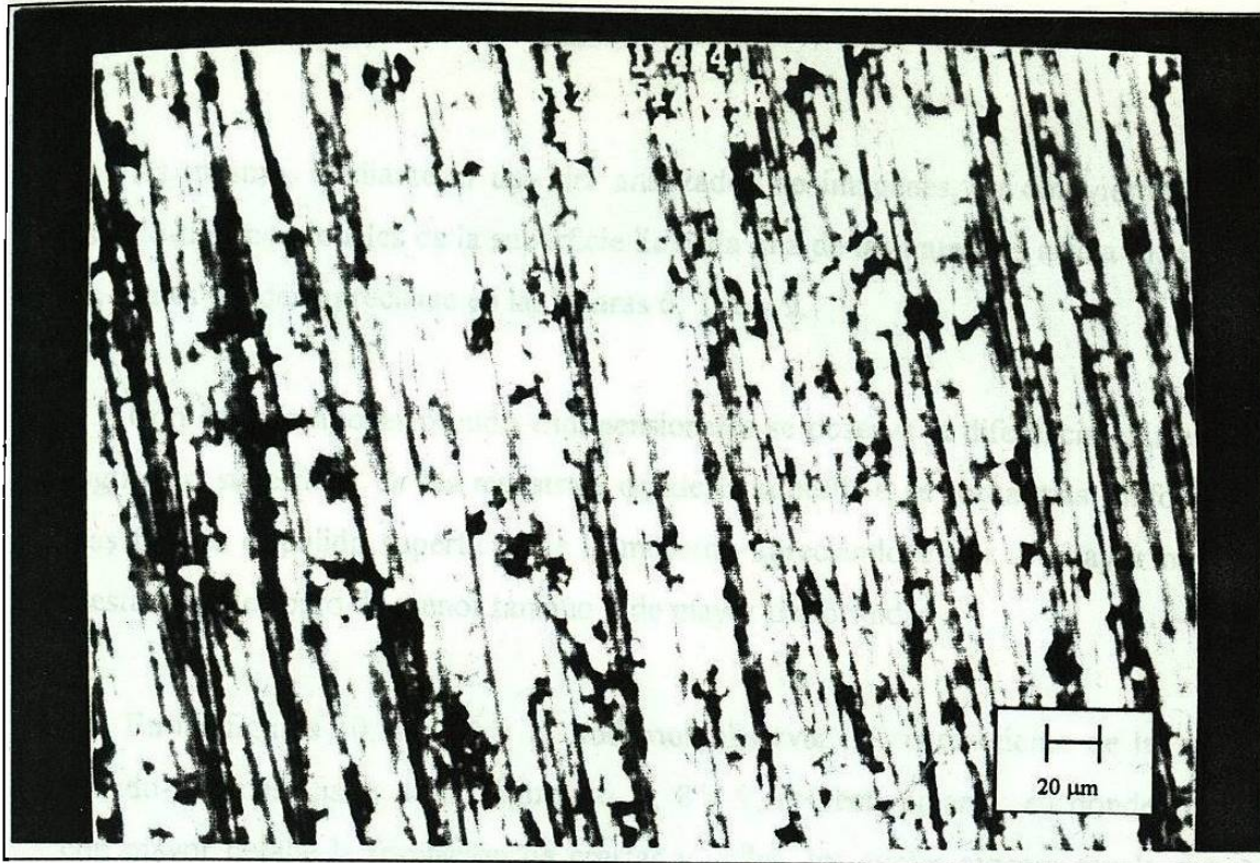
Fig. 4.- Acero 316L, sin oxidar, pulido lija 400 SiC. 200X
