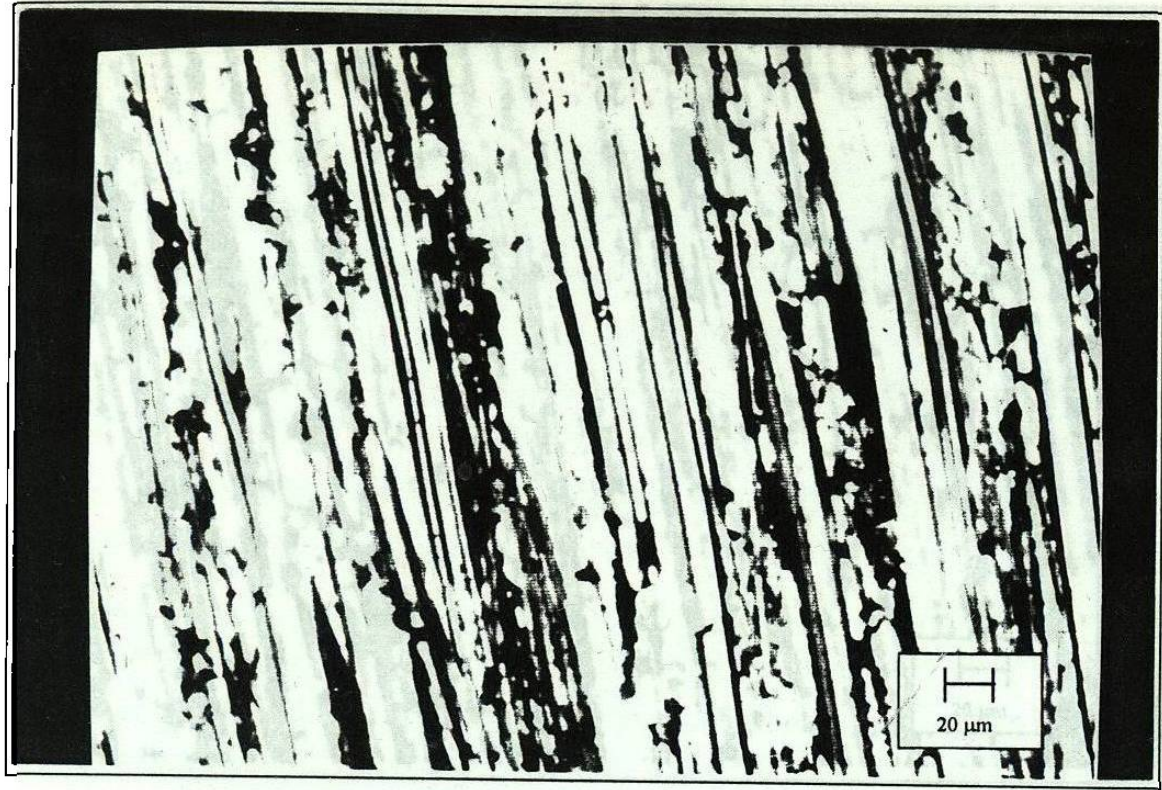
Fig. 2.- Acero 316L, sin oxidar, pulido lija 180 SiC. 200X
