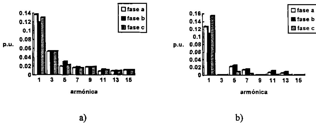
Figura 7.24. Magnitud de las armónicas del voltaje. a) Lado delta. b) Lado estrella.
