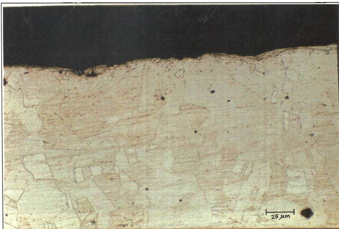
Figura 6.13. Inox. 304 zona inferior desgastada a 400X.
