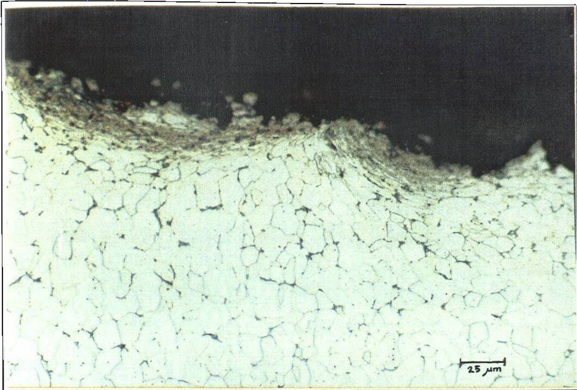
Figura 6.7. AISI 1005 zona inferior desgastada a 400X
