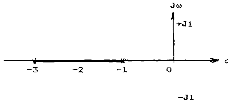
Fig. 8-5. Ubicación de Polos y Lugar Geométrico en el Eje Real
