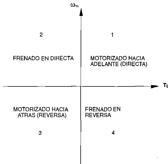
Figura 1.2 Diagrama Par - Velocidad de Cuatro Cuadrantes.
