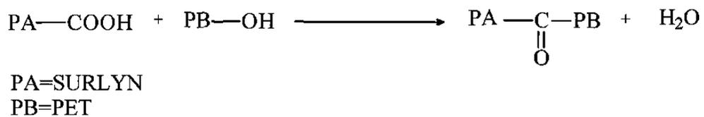
**Figura 24.** Reacción de esterificación entre un grupo COOH del compatibilizador y un OH terminal del PET.
