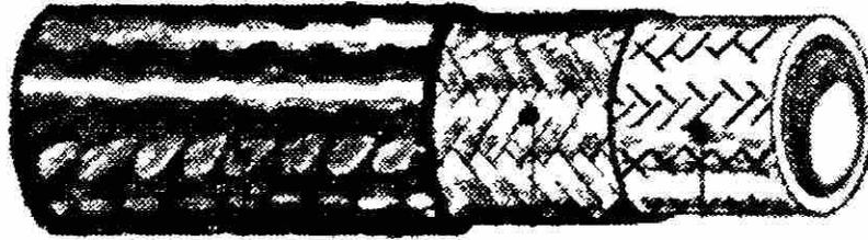
**Figura 10.1** Estructura de un tubo flexible
