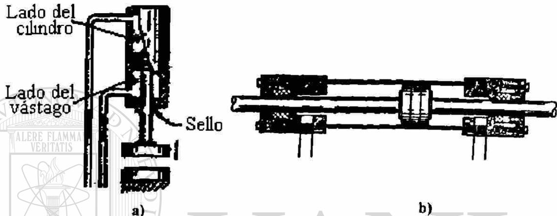
**Figura 6.4.** Cilindros de doble efecto
