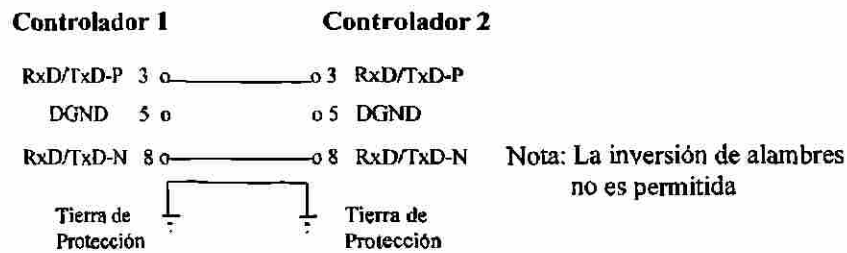
Fig. E.5 Alambrado de interconexión
