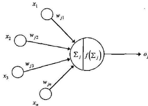
Fig. 4.14 Ilustración de un nodo de procesamiento (neurona).
