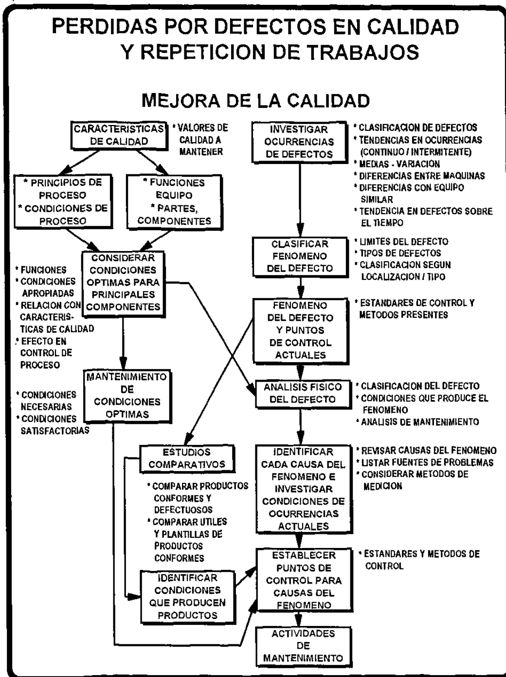
Figura 5.5 Pérdidas por defectos en calidad y repetición de trabajos
